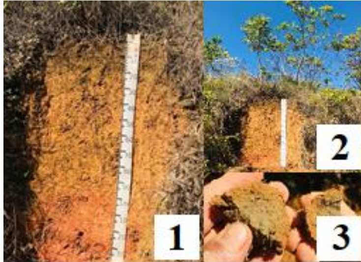
Figura 11 – Características marcantes do Perfil 4. 1 – Destaque do perfil. 2 – Proteção do solo pela vegetação 3 - Mudança de cor devido a redução do ferro por água aprisionada
